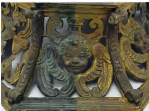
Fig. 4 Pulitura laser del basamento.
